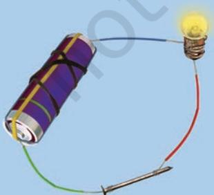
Fig. 4.2 : Electric tester
